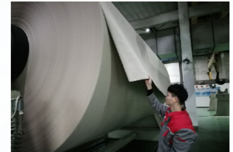
安徽山鹰 PM2 低克重瓦楞纸技改，将新闻纸生产线改开成改开低克重高强瓦楞纸产线，生产效率得到大幅提高。
